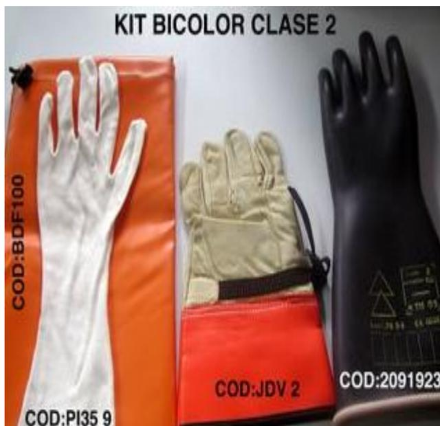
Guante dieléctrico de goma para usos en trabajos bajo tensión por debajo del voltaje máximo especificados por la norma Internacional CEI903 para las clases 00, 0, 2, 3, 4, respectivamente AC 500/ DC 750; AC 1.000,00/ DC 1.500,00, AC 17.000,00/ DC 22.500,00; AC 26.500,00/ DC; 39.750,00; AC 36.000,00/ DC 45.000,00.
